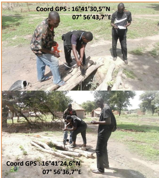
Mesure de la profondeur du puits.
